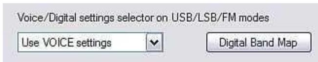
Переключатель настроек **VOICE/DIGITAL** используется для контроля автоматического переключения, когда рабочая частота в "цифровом диапазоне", как он определен в "**Digital Band Map**", и трансивер находится в режимах USB, LSB или FM.
