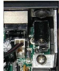
**ЗАМЕЧАНИЕ:** Начиная с серийного номера 900, этот джампер имеет три положения. Соединение левой пары контактов выбирает разъем питания 1.38 В; соединение правой пары контактов выбирает питание от разъема DB37.
