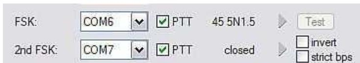
Второй порт FSK полезен при работе сплитом (split) с использованием трансиверов, имеющих два приемника (например FT-1000, FT-2000, FT-9000, K3, Orion или IC-7800). Вторая копия RTTY-программы должна использовать "right channel" (правый канал) в качестве источника звука и второй порт FSK для выхода FSK.
